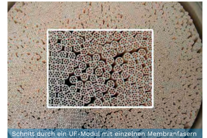
Schnitt durch ein UF-Modul mit einzelnen Membranfasern
