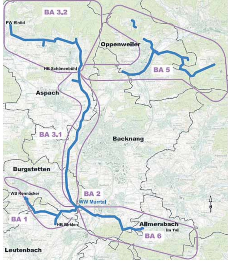
Der Leitungsbau erfolgt in insgesamt sechs Bauabschnitten (BA 1 bis BA 6).
